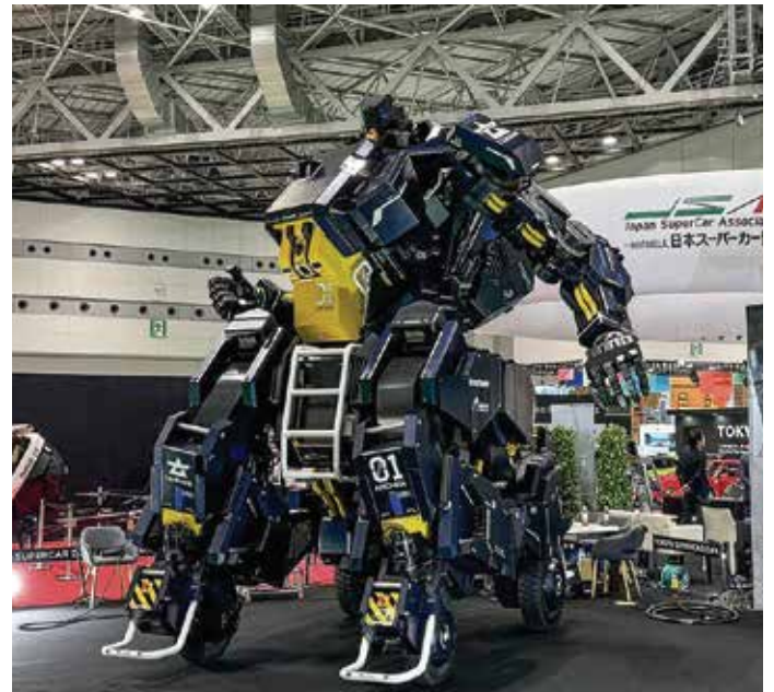
El imponente robot Archax parece salido de un episodio del anime Gundam. Se acciona desde adentro y tiene 26 puntos de articulación.
